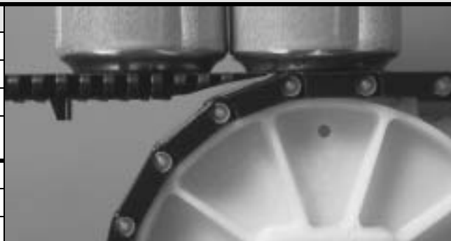
Banda de doble lengüeta de alineación de 6,0 pul. (152 mm)
