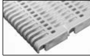
SERIE 400 • Acción central • Articulación cerrada • Paso de 2 pul. (50,8 mm)
