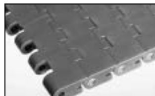
SERIE 1400 • Acción central/por articulación • Articulación cerrada • Paso de 1 pul. (25,4 mm)
