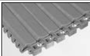
SERIE 2400 • Accionamiento sobre bisagra • Bisagra abierta • Flexión lateral • Paso de 1,0 pul. (25,4 mm)
