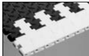
SERIE 1400 NON SKID • Acción central/por articulación • Articulación cerrada • Paso de 1 pul. (25,4 mm)
