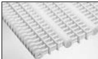
SERIE 200 • Acción por articulación • Articulación cerrada • Paso de 2 pul. (50,8 mm) • Sin borde al ras
